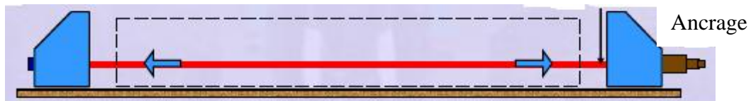
Mise en tension des câbles
