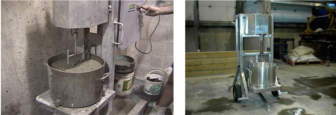
Figure 3.1 : Rhéomètre IBB. À gauche la version originale et à droite la version portable
