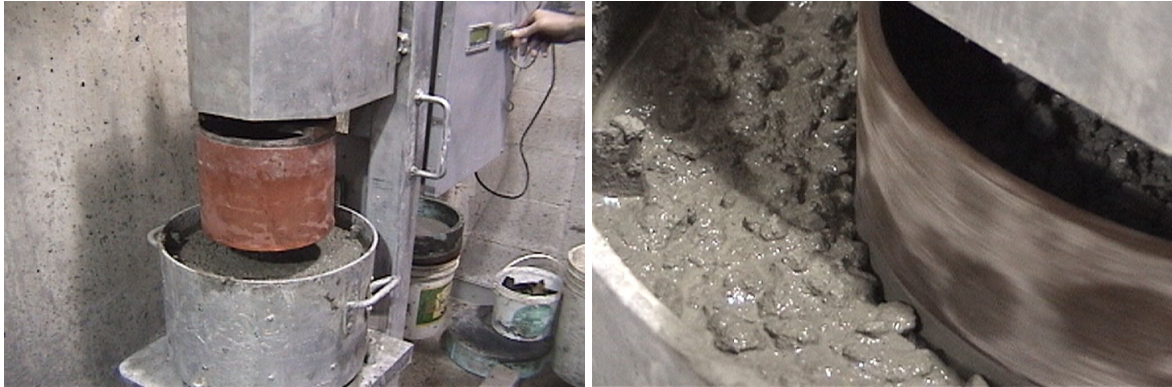
Figure 2.2 : Photos du tribomètre : à gauche, vue générale avec tribomètre en caoutchouc et à droite, vue de près avec tribomètre en acier en mouvement.
