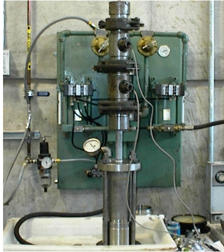
Figure 3.6 : Montage utilisé pour l'étalonnage des capteurs de pression en laboratoire
