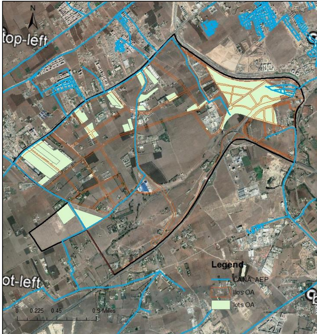
Figure 30 : les canalisations d'alimentation en eau potable existantes
