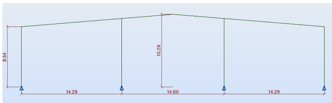
Fig.36 : Géométrie du portique de notre hangar
