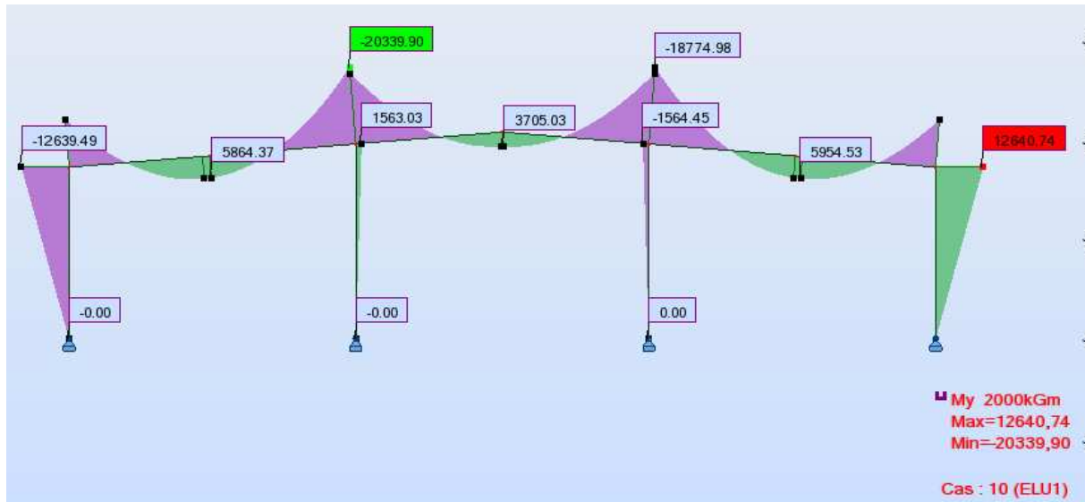
Fig.59 : Diagrammes des moments (PRS)
