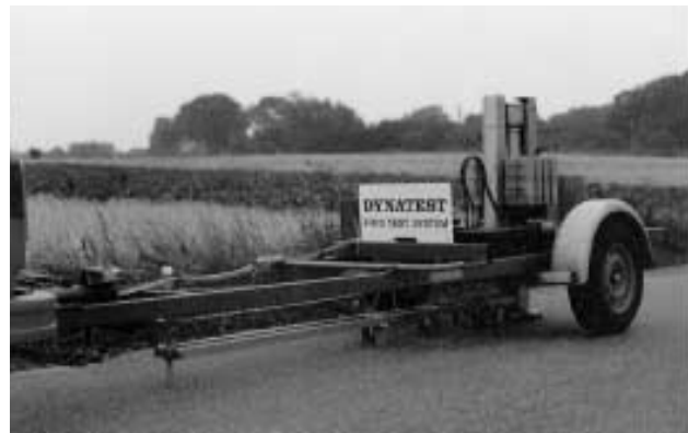
Appareillage pour la mesure de la déflexion par mouton en cours de mesure
