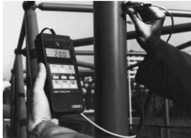
Appareil pour la mesure de l'épaisseur de peinture selon le principe d'induction magnétique
