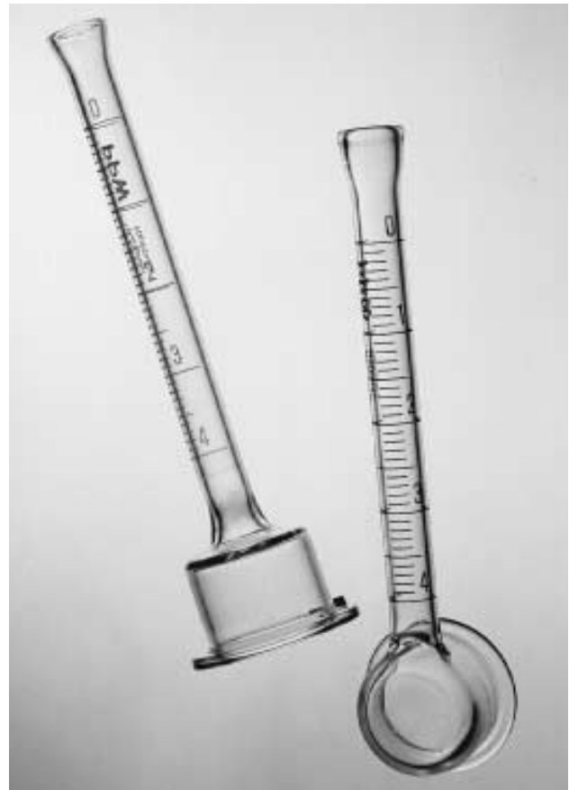
Tubes pour l'essai d'absorption d'eau selon Karstens
