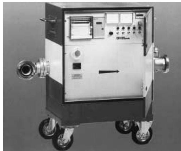
Appareillage de mesure pour la mesure des pertes par petits secteurs
