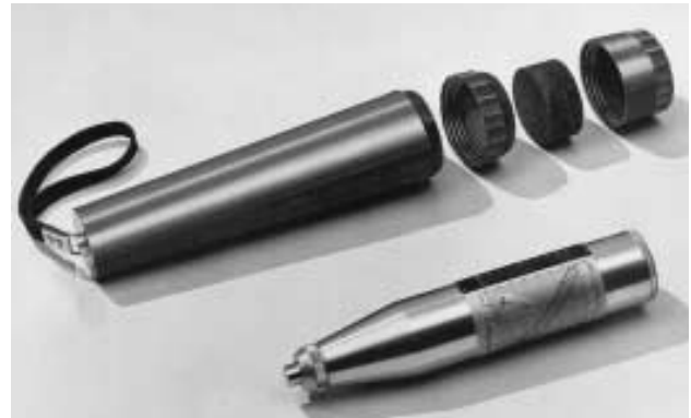
Scléromètre. modèle simple
