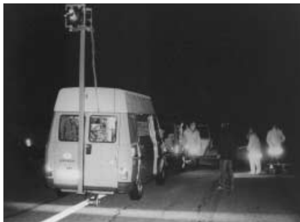
Véhicule de mesure en cours d'enregistrement sur un pont
