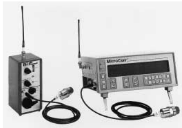
Équipement pour la méthode par corrélation acoustique
