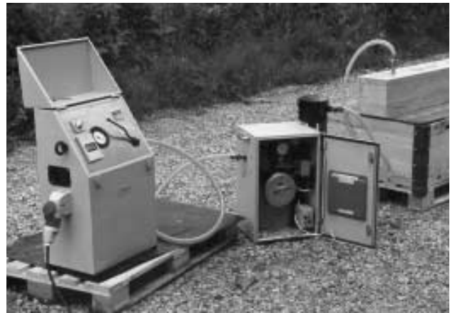
Pompe vacuum avec appareillage pour la mesure du volume aspiré
