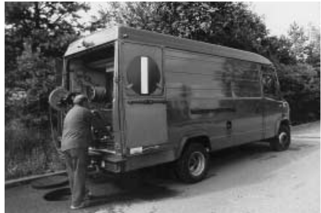
Véhicule pour caméra de télévision pour canalisations
