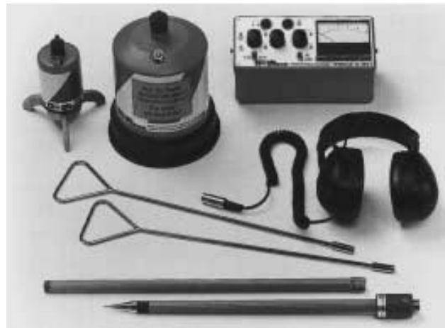
Equipement pour le repérage acoustique des pertes depuis la surface
