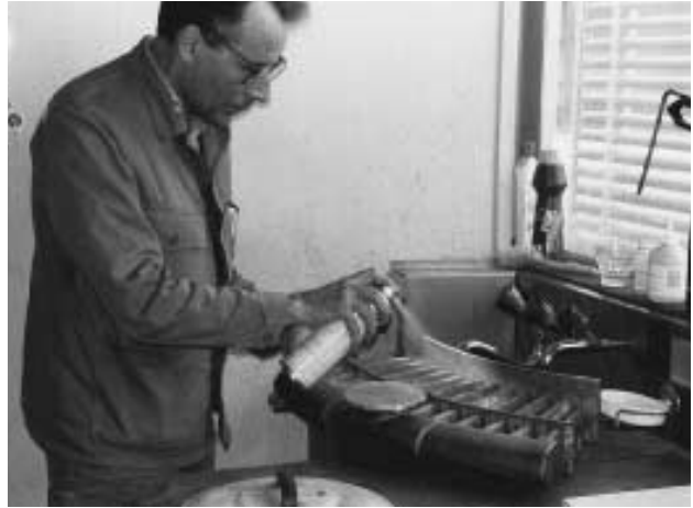
Essai de ressuage sur l'ouvrage
