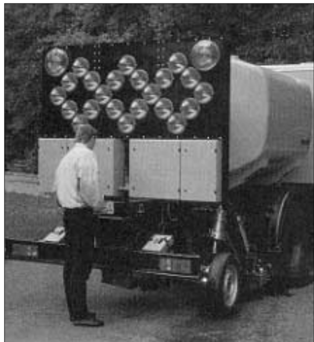
Véhicule SRM vu de l'arrière, panneau de signalisation et roue de mesure
