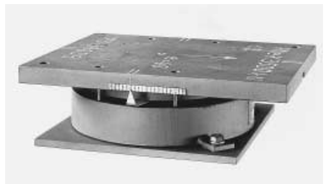
Appui de pont avec repère et échelle graduée visibles à grande distance, par exemple avec des jumelles
