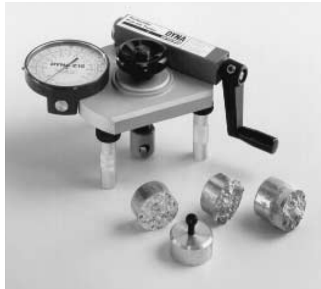
Appareillage pour l'essai d'arrachement
