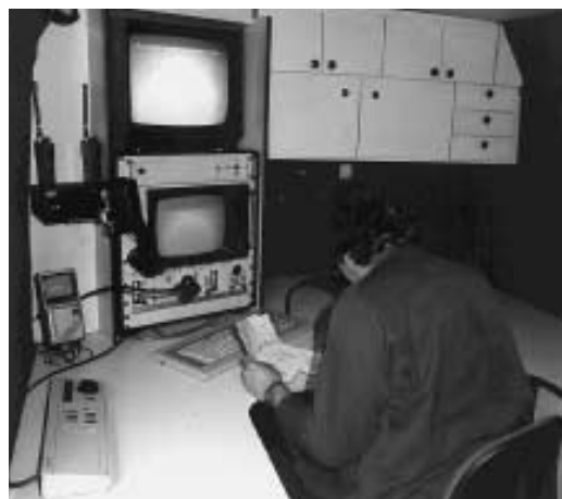
Vue de l'intérieur d'un véhicule pour caméra de télévision pour canalisations
