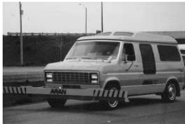
Véhicule de mesure ARAN, en cours de mesures
