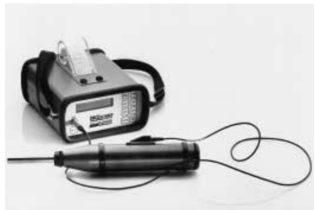
Scléromètre, modèle avec indicateur et interprétation électronique
