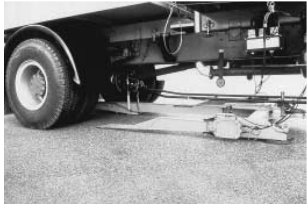
Défectographe Lacroix; détail de l'équipement de mesure
