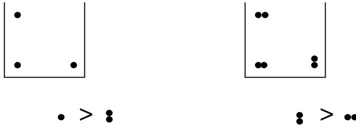
d. La résistance du béton : L'adhérence augmente avec l'augmentation de la résistance à la compression du béton.
