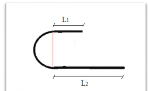
Pour les armatures transversales  $\begin{cases} R \geq 2\phi \text{ pour RL} \\ R \geq 3\phi \text{ pour HA} \end{cases}$
