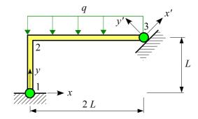
Elle est articulée en 1 et repose en 3 sur un appui incliné à  $45^{\circ}$  par rapport à l'axe x. Soit E le module de Young du matériau.
