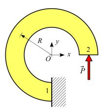
L'énergie de déformation due à l'effort tranchant est prise en compte (modèle de **Timoshenko**).
