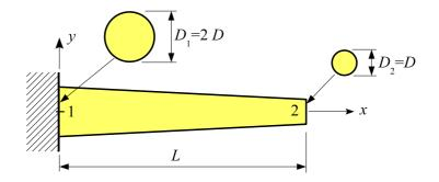
Soient E et  $\rho$  respectivement le module de Young et la masse volumique du matériau. La section droite est un rond plein dont le diamètre varie linéairement entre les sections 1 et 2. La poutre est soumise son poids propre. Soit g l'accélération de la pesanteur.
