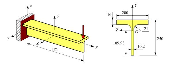
L'extrémité de la poutre est soumise à une force de composantes (0, 0 - 100) kN.
