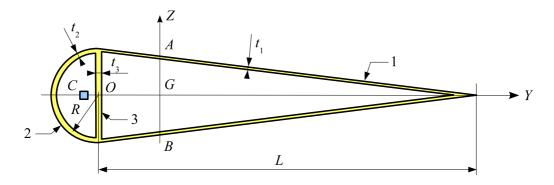
On donne :  $L=600~\mathrm{mm}$  ,  $R=75~\mathrm{mm}$  ,  $t_1=2~\mathrm{mm}$  ,  $t_2=4~\mathrm{mm}$  ,  $t_3=3~\mathrm{mm}$ .
