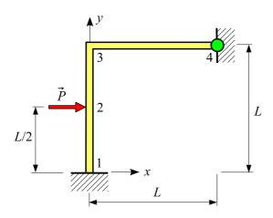
Soient A l'aire des sections droites et  $I_Z$  leur moment quadratique par rapport à l'axe Z. L'ossature est encastrée en 1 et articulée en 4. Les poutres sont en acier de module de Young E.
