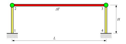
La poutre 2-3 est articulée en 2 et 3. L'ensemble est encastré en 1 et 4. Soient E et  $\alpha$  respectivement le module de Young et le coefficient de dilatation du matériau.
