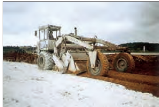
Malaxeur à arbre horizontal garantissant une épaisseur de couche de sol traité constante pouvant atteindre 0,35m avec une finesse de mouture remarquable.
