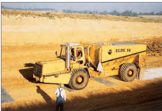
Epandeur moderne présentant un coefficient de variation voisin de 5%.
