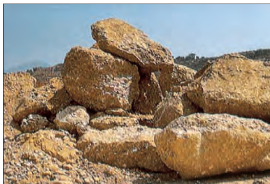
Roche siliceuse (poudingue) de la classe R 42 .
