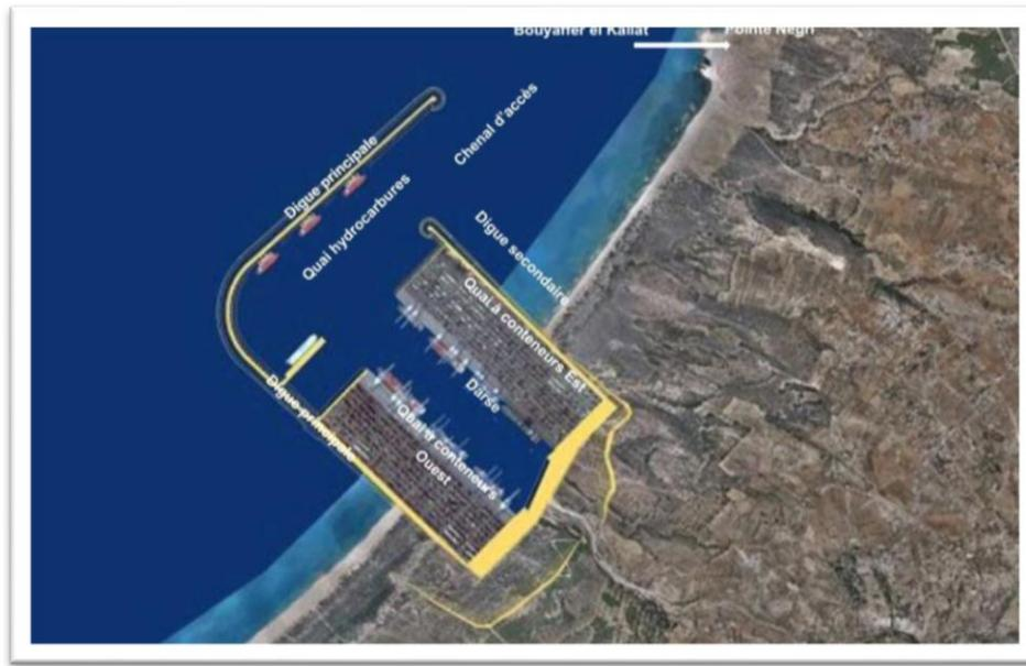
Figure 3 : Vue schématique de l'emplacement du port dans le site et de ses principaux ouvrages [3]
