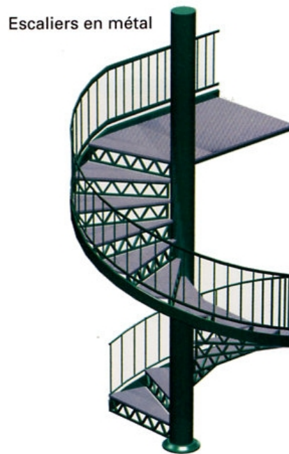
Figure 6.23 : Marches en console pour escalier hélicoïdal
