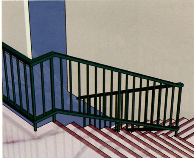
Figure 6.29 : Garde-corps dans un escalier
