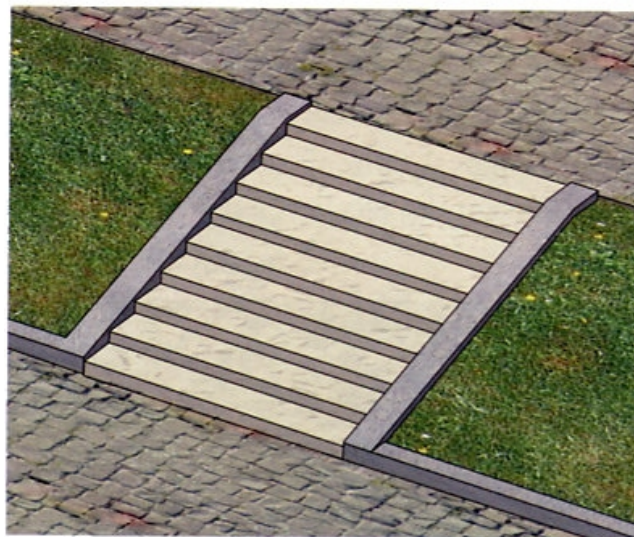
Figure 6.28 : Escalier en accompagnement de talus
