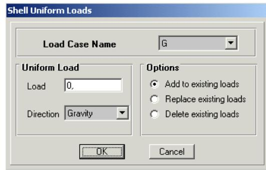
Dans le cas où vous utilisez la deuxième méthode pour la définition du matériau, il suffit dans ce paragraphe d'attribuer les surcharges d'exploitation aux éléments Shell de votre plancher comme une charge uniformément répartie.
