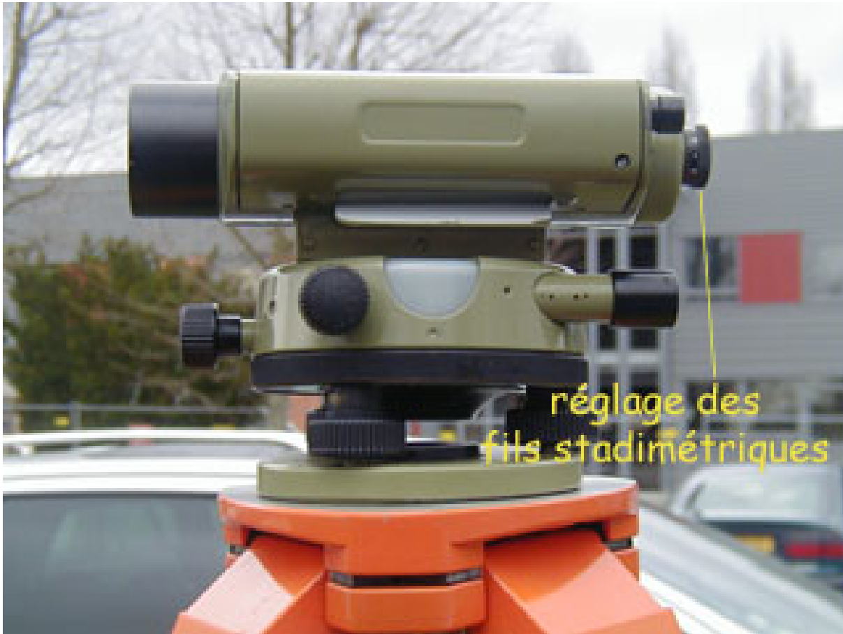
▲ IMG. 29 : MISE AU POINT DU RÉTICULE
