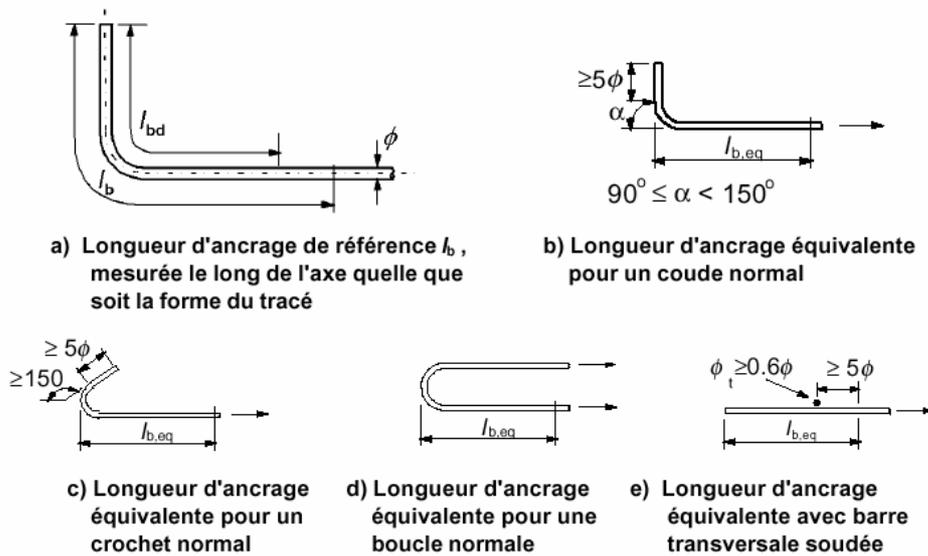
Figure 8.1 : Méthodes d'ancrage autres que le scellement droit
