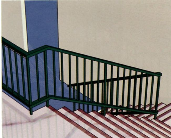
Figure 6.29 : Garde-corps dans un escalier
