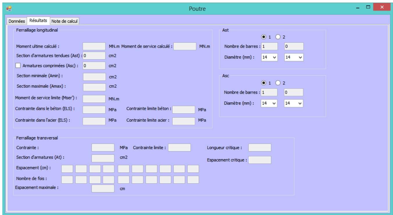
FIGURE 63 : INTERFACE DES RESULTATS POUTRE
