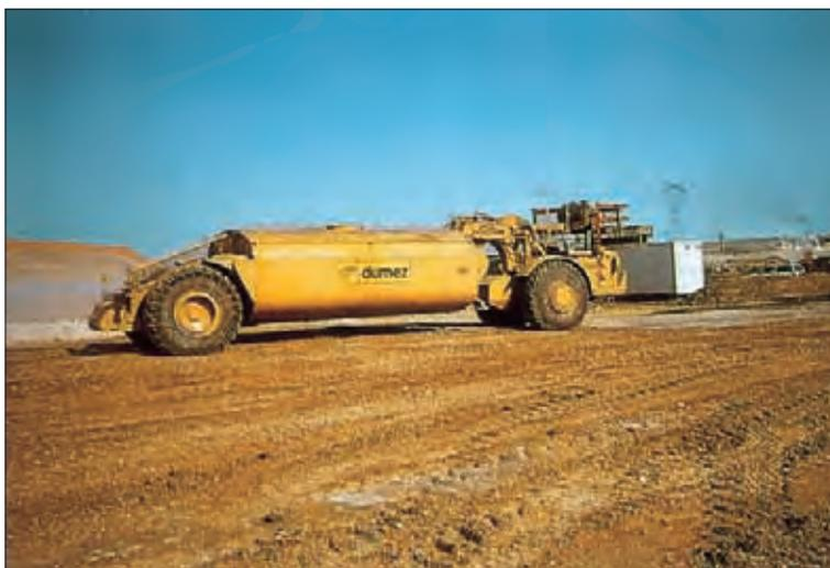
*L'humidification des sols trop secs nécessite d'approvisionner de grandes quantités d'eau (souvent plus de 100 litres d'eau par mètre cube de sol) comme le montrent les imposantes dimensions de l'arroseuse représentée sur la photo (100m<sup>3</sup>)*
