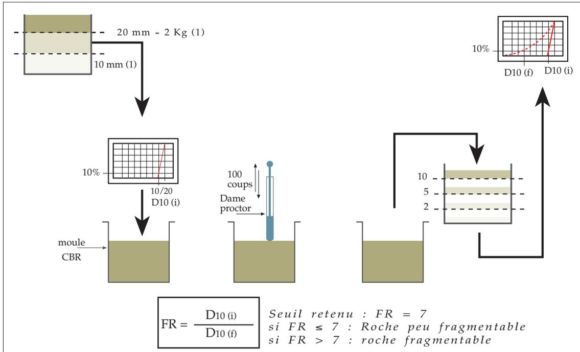
Figure 2 : Principe de l'essai de Dégradabilité (DG)
