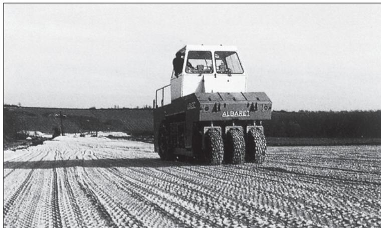
Les compacteurs à pneus sont lestables pour atteindre la charge par roue maximale prévue par le constructeur. Il y a généralement un rapport de l'ordre de 1 à 2 entre le poids à vide et le poids lesté. La recherche de la meilleure efficacité conduit à utiliser la charge par roue maximale compatible avec la "traficabilité".
