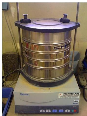
Figure 2 : Tamis et système de vibration
