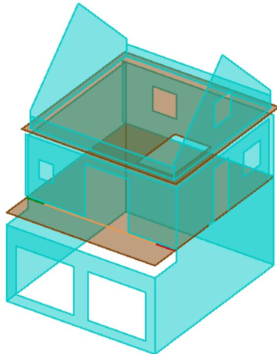
Remarque : si des objets (murs, planchers) n'apparaissent pas dans la vue analytique, il est probable qu'elle n'aient pas de « structure ». Depuis une vue architecturale, sélectionner les éléments manquants (par famille ou un par un), et cocher la case structure dans les propriétés.
