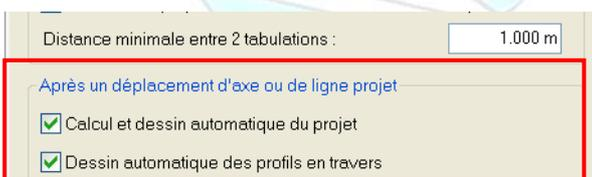
Lors du déplacement ou de l'édition de l'axe en plan ou du profil en long projet, le re-calculation du projet et le re-dessin des profils en travers peut se faire automatiquement si ces 2 cases sont cochées.
