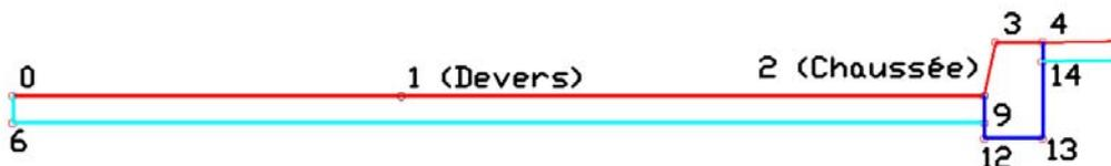
Dans le profil type ci-dessus, le point 2 de type "Chaussée" a été construit dans le prolongement de la ligne 0-1, à une distance donnée du point 0.
