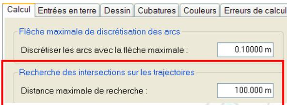
Si vous avez, dans un profil type, un point typé associé à une polygone de "suivi de trajectoire", le logiciel recherche la polygone jusqu'à une certaine distance de l'axe.
