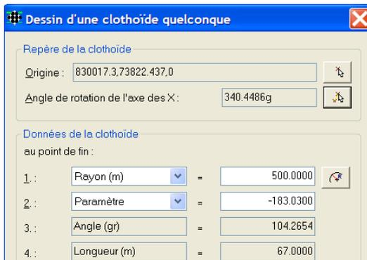
Puis dessiner la clothoïde en faisant bien attention à l'orientation de l'angle de rotation. (toujours dans le sens de la droite vers la clothoïde)
