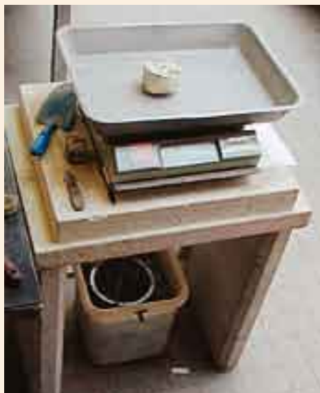
Pesée de l'échantillon puis de l'échantillon paraffiné
