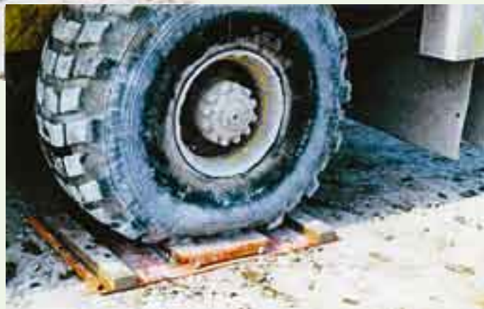
Opération de pesée de l'épandeur
