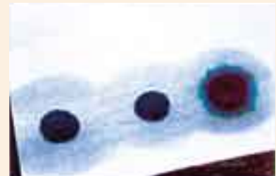
Auréole bleue apparaissant à la périphérie de la tache (fin de l'adsorption du bleu)
