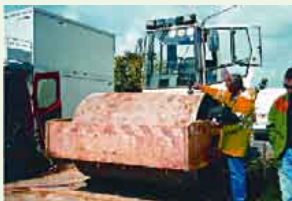
Mesure de l'amplitude et de la fréquence
