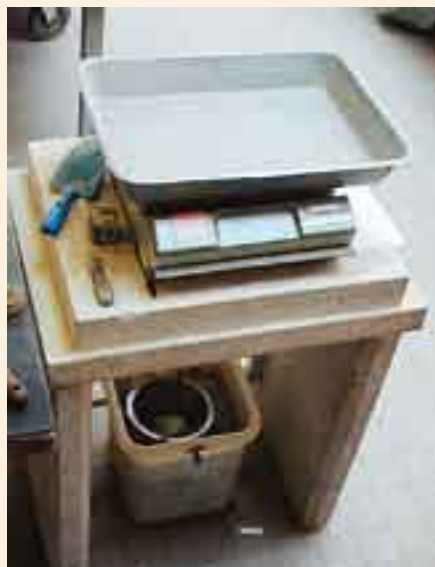
Pesée hydrostatique (échantillon immergé)
