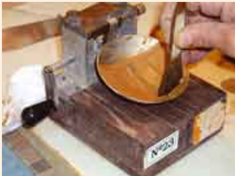
W_L : réalisation de la rainure
