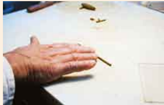
W_p : réalisation du rouleau de sol
