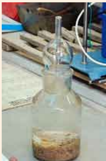
Pycnomètre avec le matériau immergé
