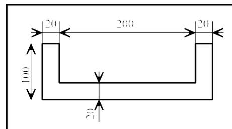
**Mi.10.** Recherchez la position du centre de gravité de la poutre ci-contre. Calculez ensuite le moment d'inertie par rapport à un axe horizontal passant par le centre de gravité.
