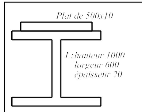
**Mi.12.** Soit une poutre en béton précontraint dont on donne toutes les caractéristiques géométriques; cette poutre est solidarifiée en phase ultime avec une dalle de béton armé de 15 cm d'épaisseur. La largeur collaborante de la dalle est estimée à 2 m.
