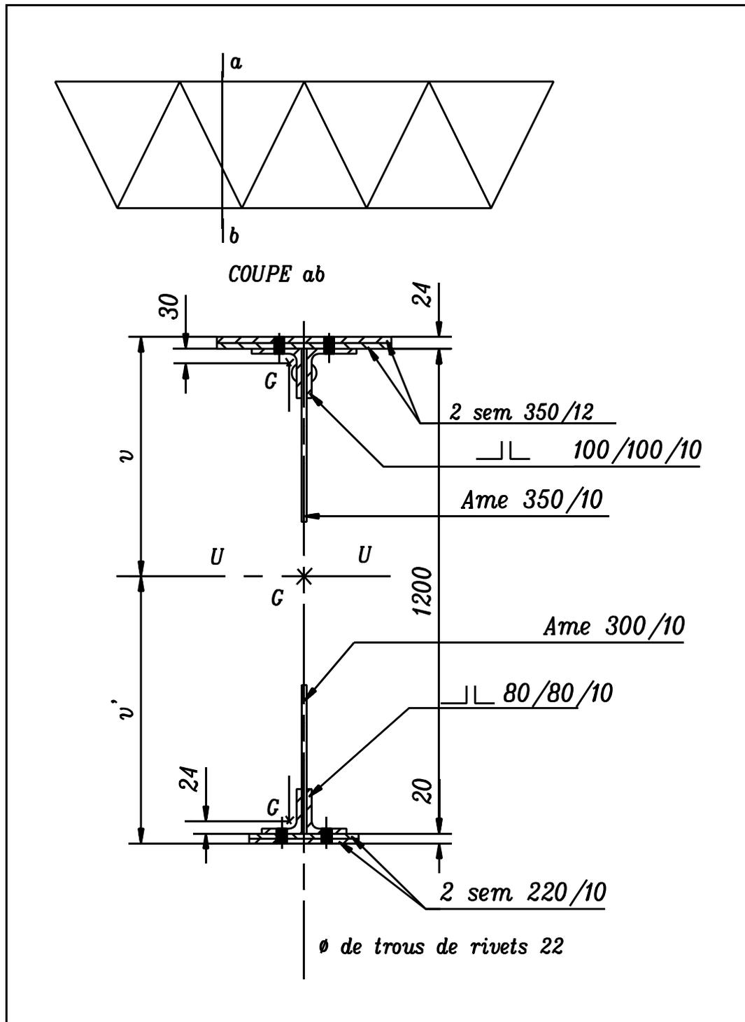
**Réponses :**  $A = 261.6 \text{ cm}^2$ ;  $v = 50,6 \text{ cm}$ ;  $v' = 73,8 \text{ cm}$ ;  $I_{UU} = 795657 \text{ cm}^4$
