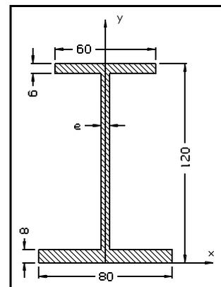
**Mi.4.** Rechercher le centre de gravité de la surface ci-contre (dimensions en mm) :
