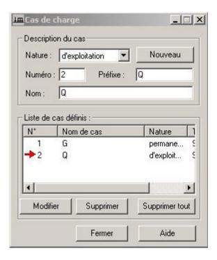
Le poids propre sera pris en compte avec la charge permanente G. Pour les charges sismiques, elles seront générées automatiquement par le logiciel. Les autre charges (vent, neige ... ) seront négligées.
