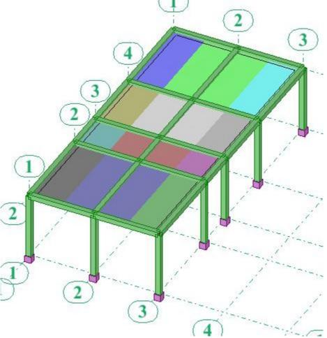
4- S on active l'option (force générée automatiquement) Robot va afficher la valeur de la charge reprise par chaque poutre :
