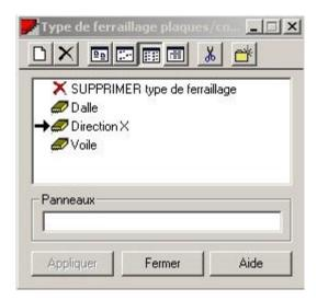
De la même manière que pour les épaisseurs, on doit définir deux types de ferraillage (un pour les dalles pleines et escalier et un autre pour les voiles). Sélectionner le type (voile) et fermer.
