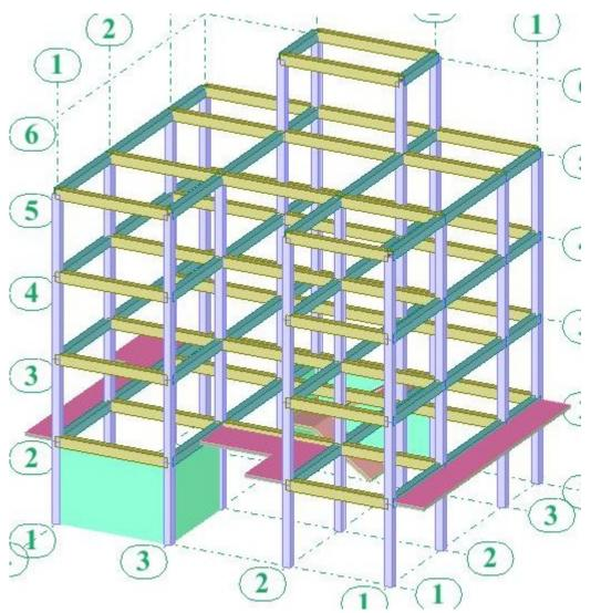
Maintenant nous allons copier les voiles, les dalles pleines et les escaliers du RDC vers le 1<sup>er</sup> et 2<sup>e</sup> étage.
