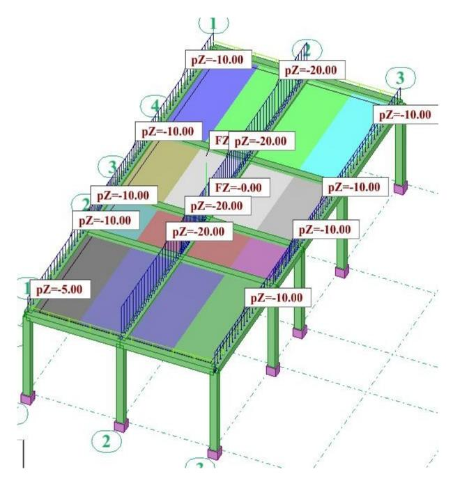
5- Il y a une autre méthode pour contrôler si on ne s'est pas trompé dans le sens porteur : il s'agit d'afficher les axes locaux du bardage :
