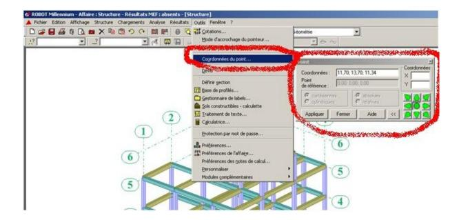
Pour cela il faut : ouvrir en même temps l'option coordonnées du point et l'option poly ligne, par la suite saisir les coordonnées manuellement du contour, par exemple les coordonnées d'une volée d'escalier (première volée du RDC) sont :
