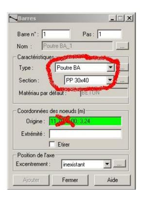
Dans le champ (type) sélectionnez poutre BA, dans le champ (section) sélectionnez (PP 30x40). Cliquez sur le champ (origine) et commencez le dessin des poutres principales. Par le même principe on peut dessiner toutes les poutres principales et secondaires du plancher niveau 3.24.
