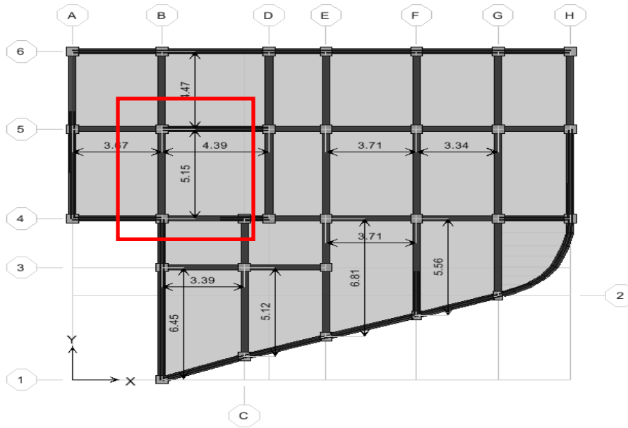
Figure.7.7. Panneaux de dalle du radier (e = 40cm)
