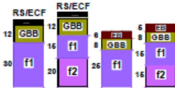
Figure 29: Structures de chaussées admises (Fiche 3)
