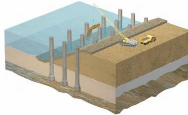
Figure 100 : Réglage du talus
