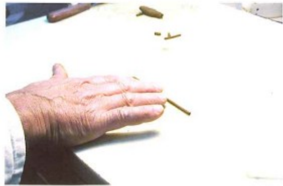
W_p : réalisation du rouleau de sol
