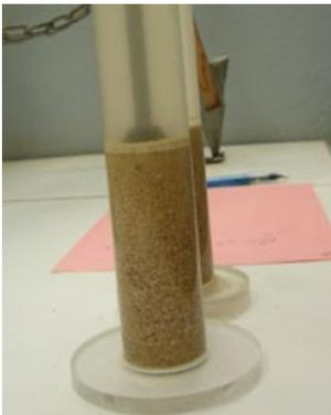
Il est aussi possible de prendre cette mesure à l'aide d'un piston normalisé qui traverse la couche d'argile pour se poser sur le sable brut. La hauteur totale du sable se mesure comme précédemment. La longueur de la tige du piston correspond à la hauteur de l'éprouvette. La mesure de la longueur de la tige qui n'a pas pénétrée dans l'éprouvette correspond alors à la hauteur de sable brut.
