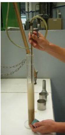
Les éléments argileux floclés sont ensuite remontés à l'aide d'un tube plongeur qui injecte de la solution « lavante ». Les bords supérieurs du tube sont aussi nettoyés pour que l'ensemble de l'échantillon soit plongé dans la solution. Le tube est plongé au fond de l'éprouvette et remonté lentement pendant que l'éprouvette est tournée également lentement.
