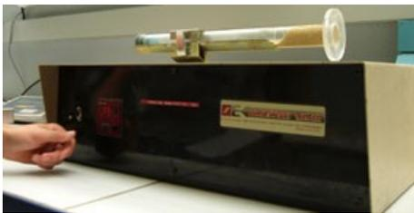
L'éprouvette est ensuite placée horizontalement dans une machine à vibrer automatique. L'éprouvette est vibrée 90 fois en 30 secondes.
