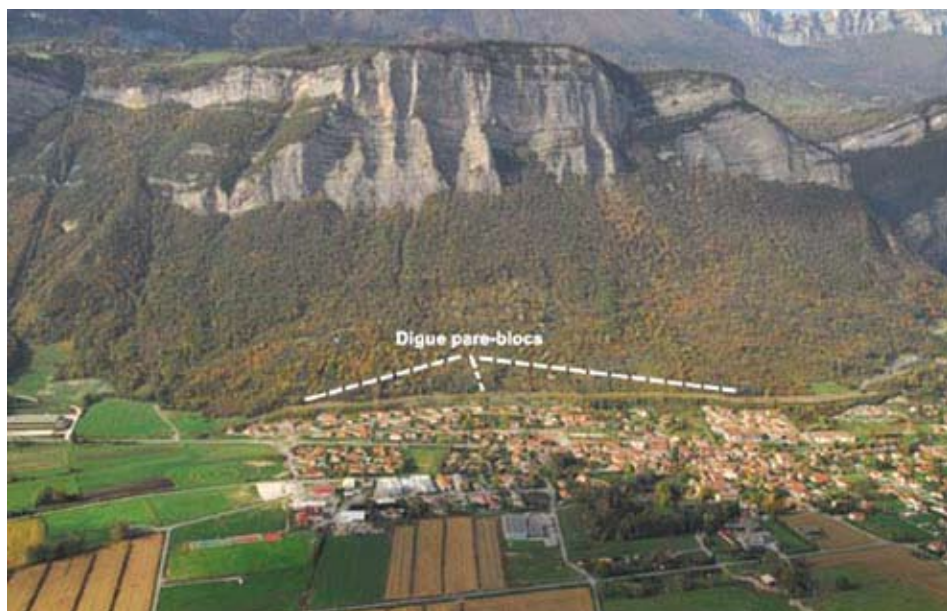
▲ Figure 28 : merlon et filets contre les chutes de blocs, dans la Commune de LUMBIN en ISERE
