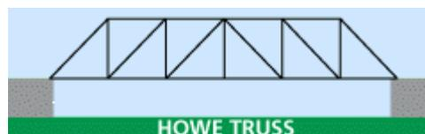
Pour obtenir une ferme à treillis ayant un poids minimal, on aurait tendance à choisir la section de chaque barre en fonction de l'intensité de l'effort normal au quel elle est soumise. Pour les diagonales et les montants, cela ne pose pas de problèmes, encore que l'on fasse usage d'un nombre limité de sections différentes dans un but de rationalisation. Par contre, pour les membrures, un changement de section à chaque nœud n'est pas économique à cause de travail supplémentaire que
