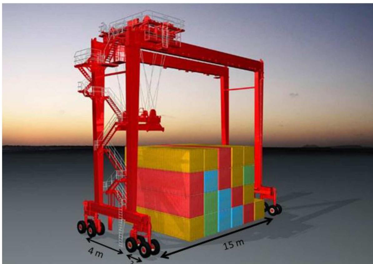
Figure 58: Dimensions d'un RTG
