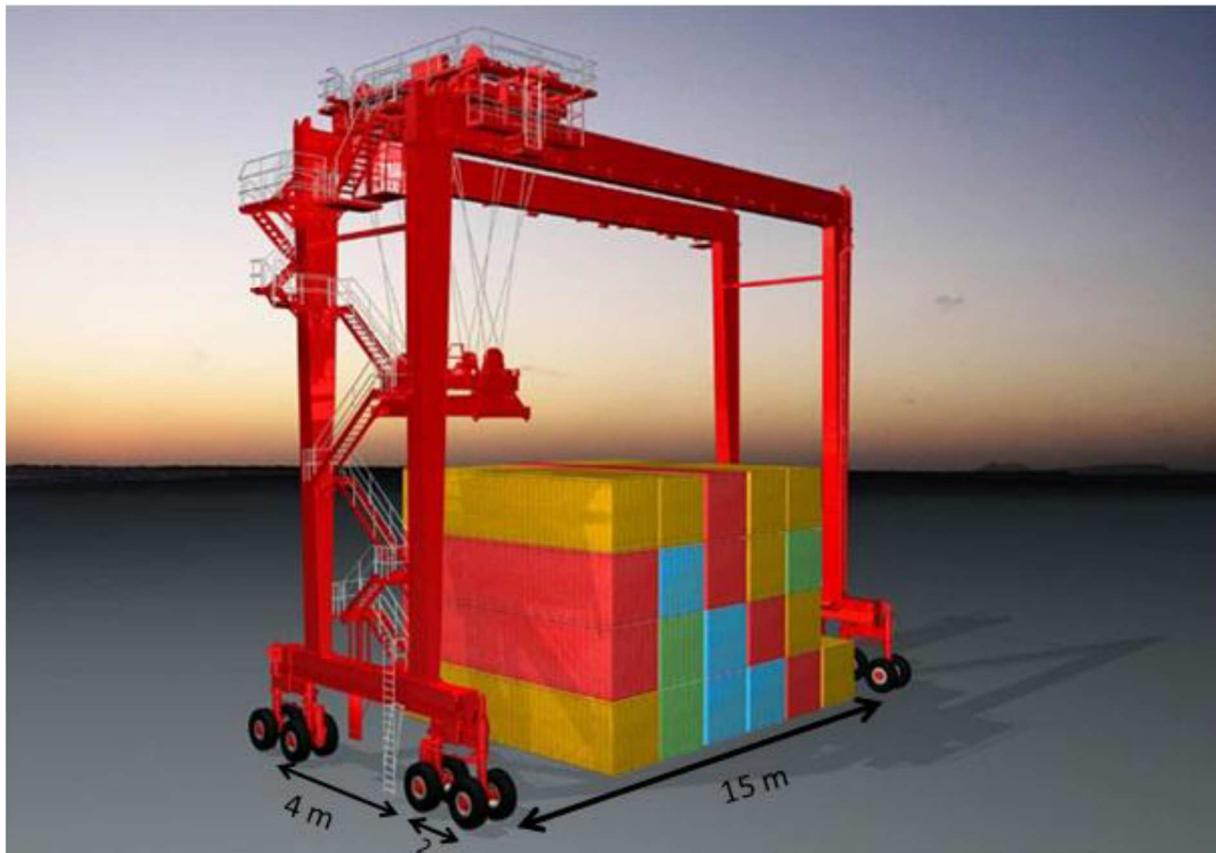
Figure 45: Dimensions d'un RTG
