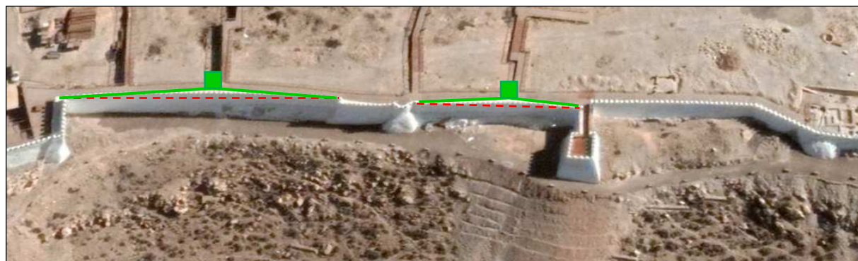
Fig. 62 : Rectification légère du tracé des parties des murs en courbe comme solution possibles aux irrégularités de la conception en plan
