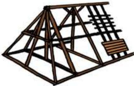
La charpente est une architecture, en bois ou en métal, qui repose sur les murs porteurs. Elle donne au toit sa forme et son volume. Elle peut être en bois ou métallique. En bois, elle sera construite artisanalement ou selon la méthode industrielle des fermettes prêtes à poser. En sachant que les fermettes ne laissent que peu de place à d'éventuels combles.
