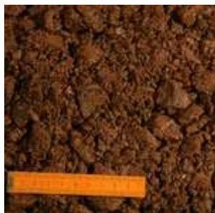
La première garantira une bonne assise à l'ensemble ainsi que sa perméabilité aux eaux de ruissellement et d'infiltration. Pour cela on utilisera une grave de type 0/20 ou 0/31.5 concassée.
