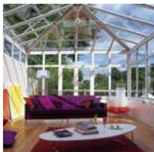
Votre véranda peut être entièrement isolée (structure à rupture de pont thermique et vitrage à isolation renforcé). Sans chauffage, une température minimale de 10°C est pratiquement garantie, même au cœur de l'hiver. Le mode de chauffage de la véranda dépend de son utilisation et de la configuration des lieux.
