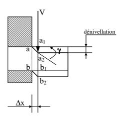
Si on admet que aa<sub>2</sub> reste rectiligne, on définit la déformation par le rapport :
