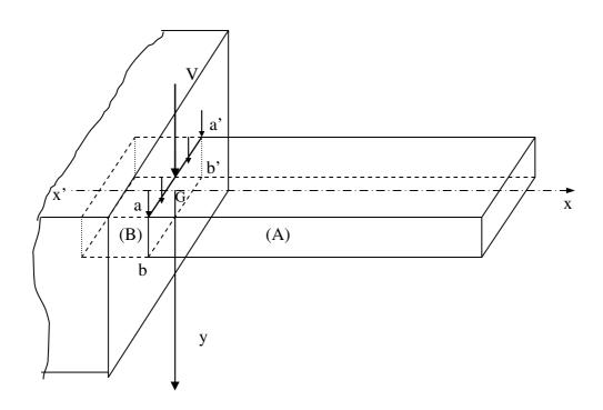
L'effort V agit dans le plan de la section droite d'encastrement aa'bb' et il est supposé uniformément réparti le long de l'arête aa'. En réalité, la section aa'bb' est très voisine de V mais à gauche de son plan d'application, du fait qu'il est impossible que V s'exerce rigoureusement dans le plan d'encastrement (fig.2). ( $\Delta x$  très petit.)
