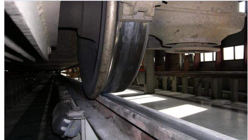
**Le principe de la circulation ferroviaire repose essentiellement sur le seul phénomène de l'adhérence au niveau du contact roue/rail.**
