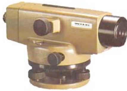
Fig. 7 – Niveau de chantier
