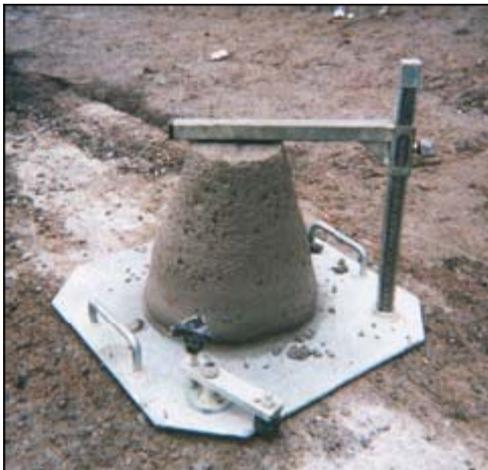
*Essai au cône d'Abrams*
