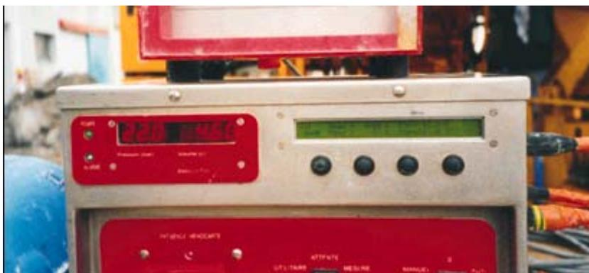
*Injection : centrale de pilotage et d'enregistrement*
