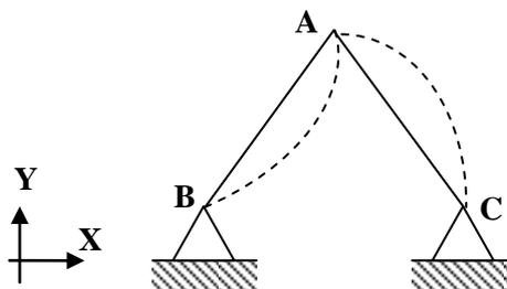
**Figure 4.7. :** Principe du nœud fixe en translation
