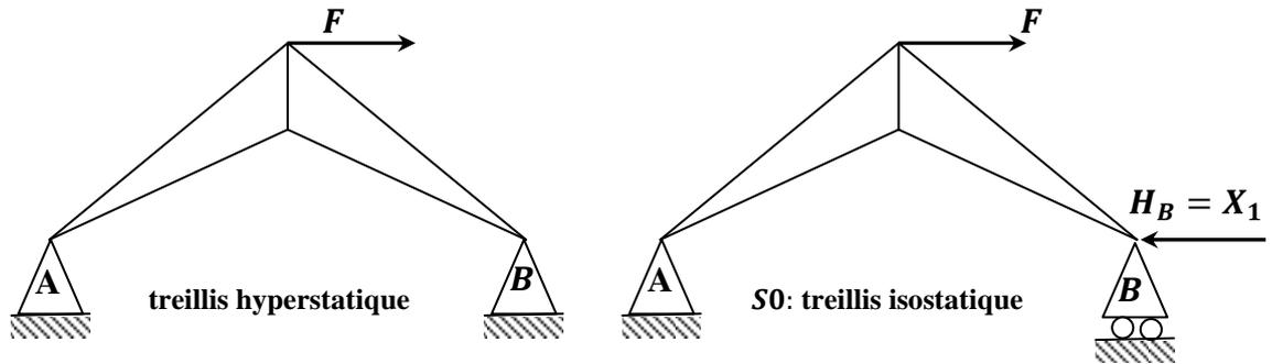
Figure 5.5. : Treillis plan extérieurement une fois hyperstatique
