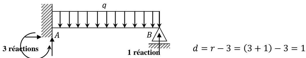
Figure 2.1. : Poutre sur 2 appuis (1 Encastrement et 1 simple)
