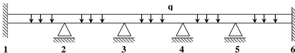
Figure 4.1. : Poutre hyperstatique
