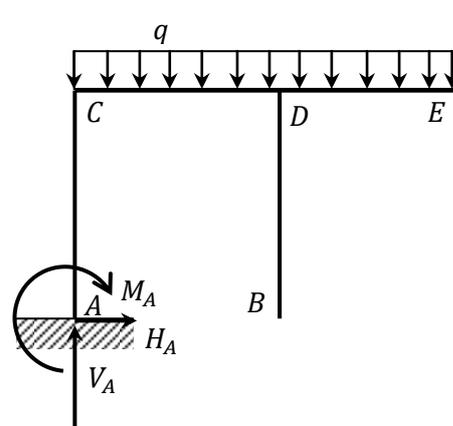
**Figure 1.6.b :** Portique isostatique
