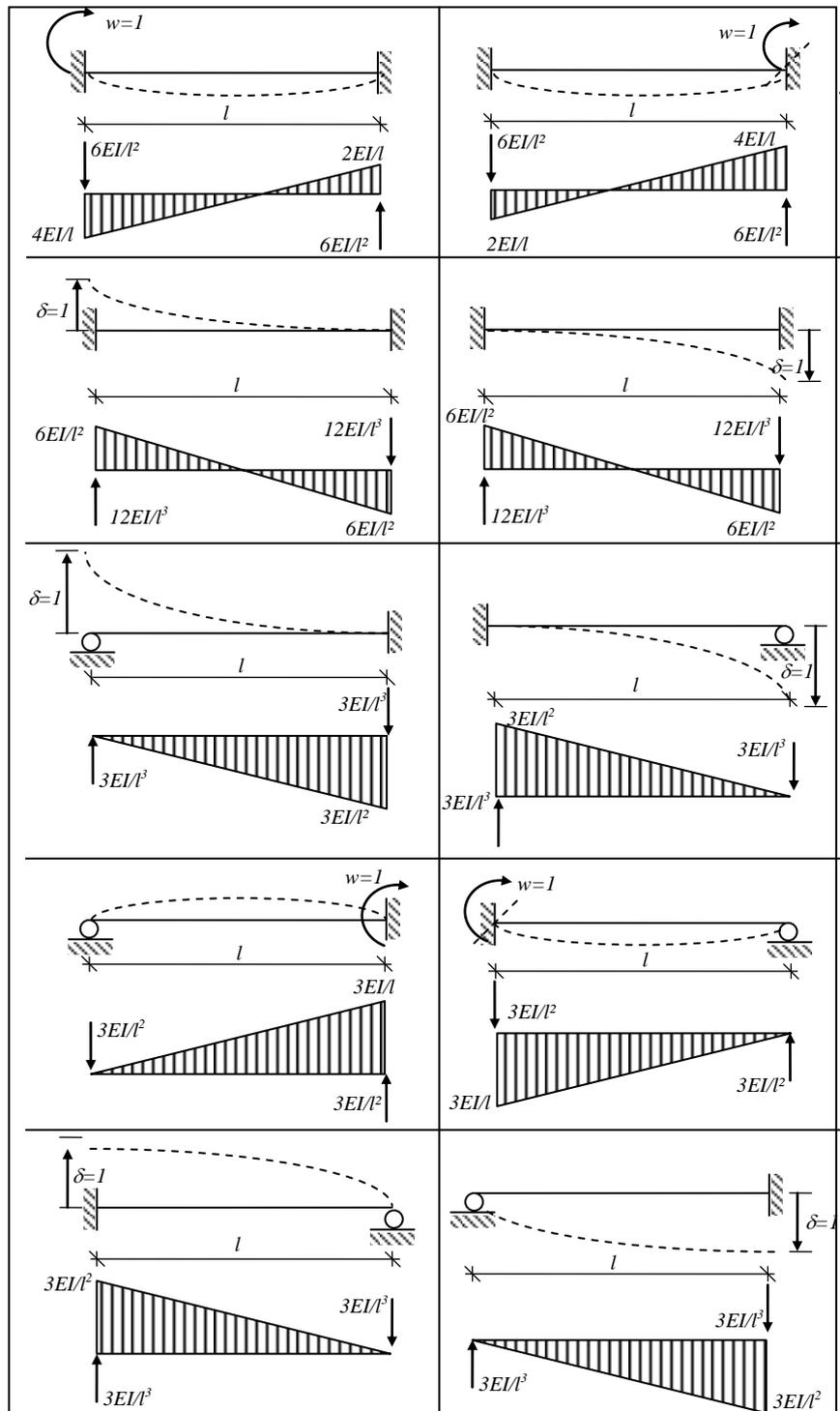
Figure 4.9. : Les moments fléchissants et les réactions des barres soumises à des déplacements d'appuis (rotations et translations)
