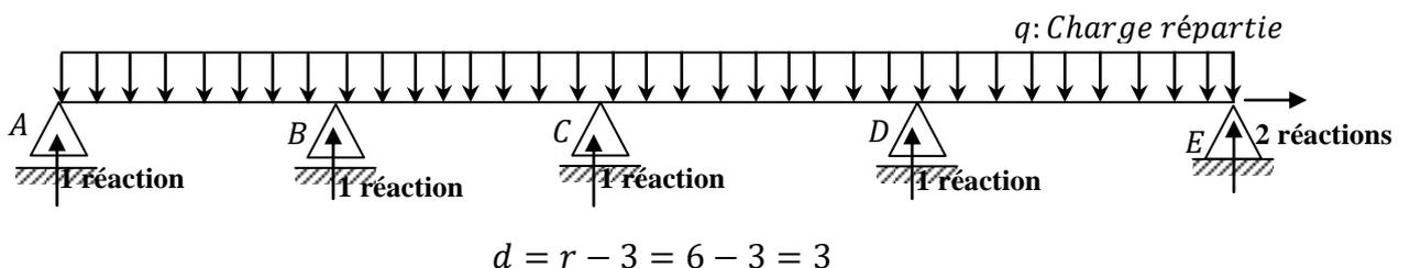
Figure 2.2. : Poutre sur 5 appuis (1 double et 4 simples)
