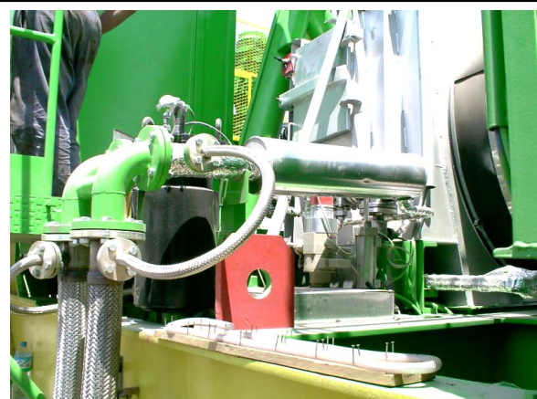
Vue de la pompe doseuse du bitume
