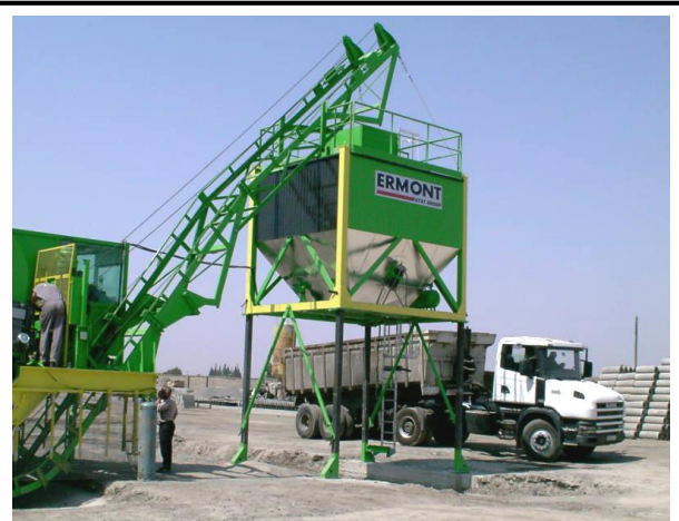
Vue de la trémie de stockage des enrobés
