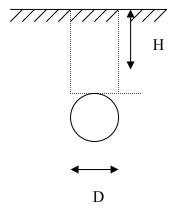
L'action d'une telle surcharge peut se calculer par la formule de Boussinesq qui assimile le sol à un milieu élastique homogène et isotrope Qs= $\mu$ Ps Où  $\mu$  est un coefficient dépendant de H/D représenter sur la figure :
