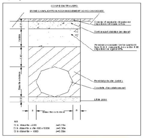
Figure 4-1 profil en travers type du réseau EU
