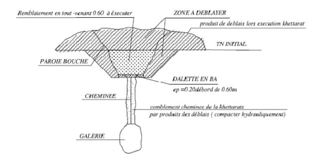
Figure 2-2 : Schéma de traitement des khettaras
