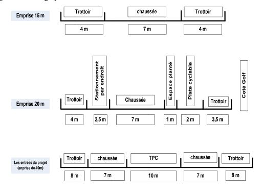
Figure 2-1 Profils en travers des voies
