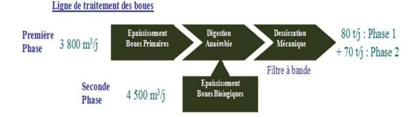
Figure 5-2 : Schéma Synoptique de la STEP de Marrakech
