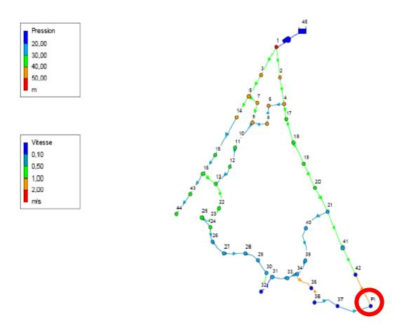
Figure 3-4 : résultat de la simulation du réseau avec poteaud'incendie ouvert
