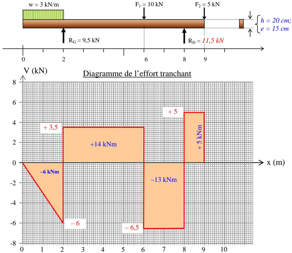
On peut lire sur le diagramme de  $V(x)$  que  $V_{max} = 6\,500\text{ kN}$  et se situe de  $x = 6\text{ m}$  à  $x = 8\text{ m}$
