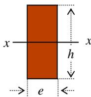
$$\tau_{\max} = 1,5 V_{\max} / h e \quad \text{avec } V_{\max} = 5\,250 \text{ N}$$
