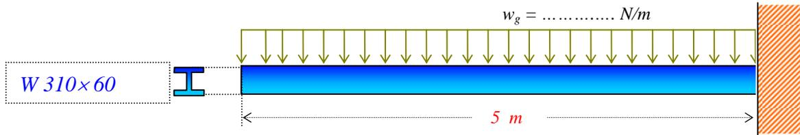
À partir du tableau E7 on obtient :  $I_{poids} = \frac{wL^4}{8E\Delta_{\max}} = \frac{585 \times 5^4}{8 \times 200 \times 10^9 \times 0,015} = 15,23 \times 10^{-6} m^4$
