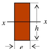
$$S_x = \frac{h^2 e}{6} \Rightarrow e = 6 S_x / h^2 \quad \text{avec } h = 0,286 \text{ m (tableau H)}$$
