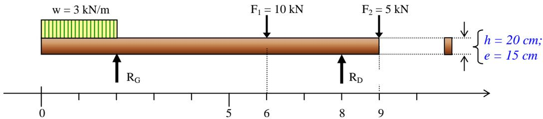
(Rép. :  $V_{max} = 6,5 \text{ kN}$  pour  $6 < x < 8$  ;  $M_{max} = 8 \text{ kN.m}$  à  $x = 6 \text{ m}$  ;  $\sigma_{max} = 8,00 \text{ MPa}$  ;  $\tau_{max} = 0,325 \text{ MPa}$  et  $F.S. = 6,9$ )
