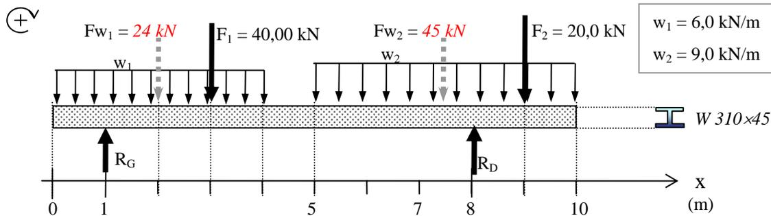
1° Déterminons d'abord  $R_G$  et  $R_D$ , les réactions aux appuis :
