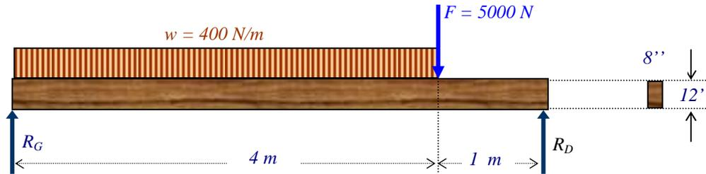
$$\text{Aire réelle du profilé} = A = 0,184 \times 0,286 = 52,624 \times 10^{-3} \text{ m}^2.$$
