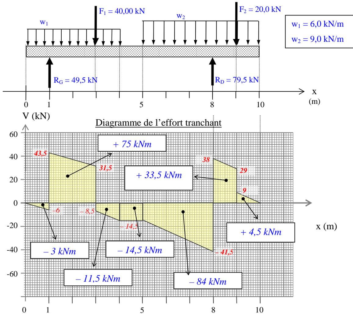
On peut lire sur le diagramme de  $V(x)$  que  $V_{max} = 43,5 \text{ kN}$  et se situe à  $x = 1^+ \text{ m}$
