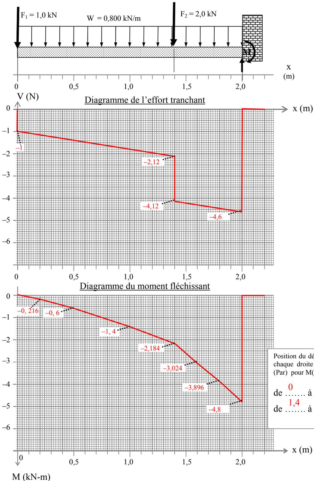
Valeur maximale (en valeur absolue) de l'effort tranchant =  $V_{max} = 4,6 \text{ kN}$  à  $x = 2,0 \text{ m}$
