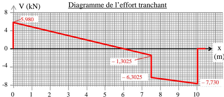
Pour calculer  $M_{max}$ , il faut d'abord déterminer  $x_{max}$  la position où  $M(x)$  aura sa valeur maximale. Ce sera pour un endroit sur la poutre où  $V(x) = 0$ . Il est donc utile de commencer par déterminer les équations de  $V(x)$  et de  $M(x)$  dans la région où  $V(x)$  passe par zéro.
