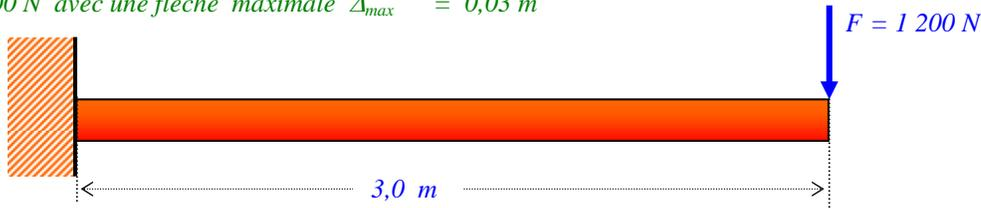
$$\text{\AA partir du tableau E11 on obtient : } I_F = \frac{FL^3}{3E\Delta_{\max}} = \frac{1200 \times 3^3}{3 \times 200 \times 10^9 \times 0,03} = 18,00 \times 10^{-7} \text{ m}^4$$
