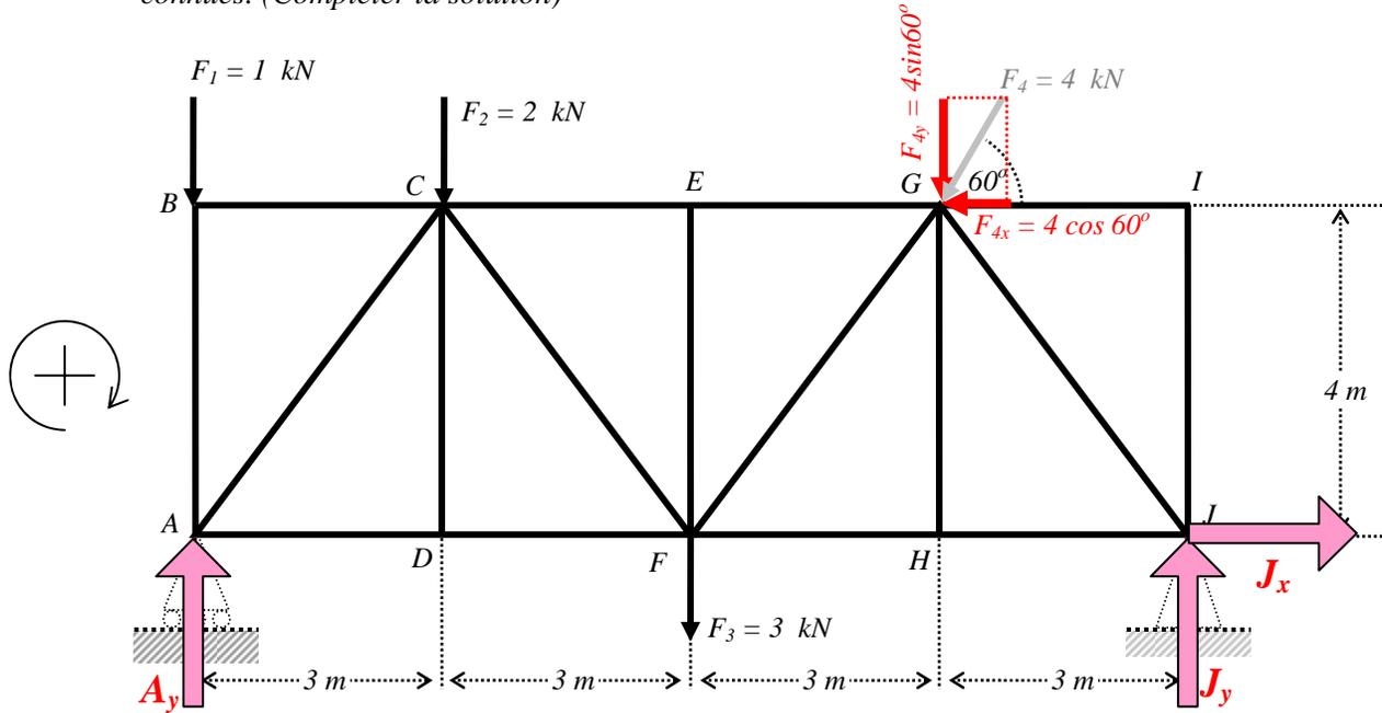
Détermination des réactions aux appuis :
