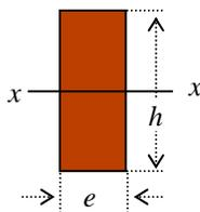
$$I_x = h^3 e / 12 \Rightarrow e = 12 I_x / h^3 \quad \text{avec } h = 0,286 \text{ m (tableau H)}$$
