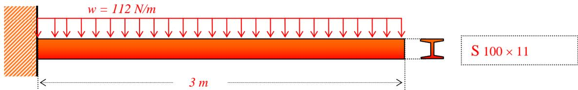
$$\text{\AA partir du tableau E7 on obtient : } I_{\text{poids}} = \frac{wL^4}{8E\Delta_{\max}} = \frac{112 \times 3^4}{8 \times 200 \times 10^9 \times 0,03}$$
