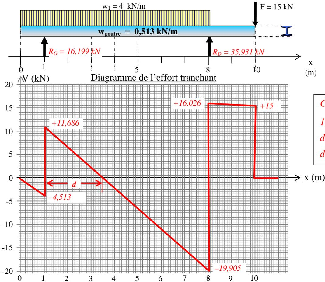
On peut lire sur le diagramme de  $V(x)$  que  $V_{max} = \dots\dots\dots$  et se situe à  $x = 8$  m
