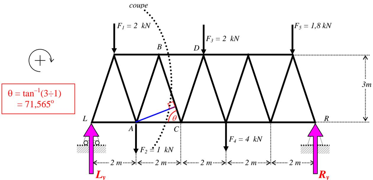
Détermination de la réaction «  $L_y$  » à l'appui gauche (en L). Pour cela on applique  $\Sigma M = 0$  à toute la structure.
